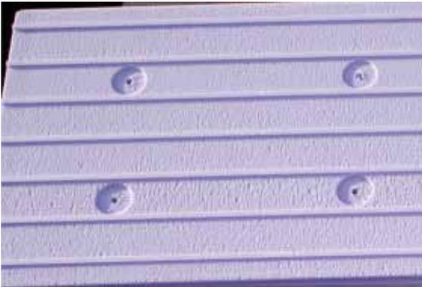
Durch die Vorfräsung der Dübelsetzpunkte innerhalb des Fugenleitsystems ist die Lage jedes Dübels vorgegeben und dadurch gewährleistet, dass die Dübel immer von Kleber und Riemchen überdeckt werden.
