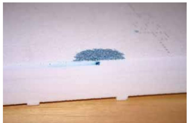
Bei den **CASAtHERM-Dämmplatten** aus XPS ist zu sehen, dass die Tinte sich nicht hereinspritzen lässt, und statt dessen an der Einstichstelle herausquillt. Die Tinte verteilt sich nur bei den gefrästen Zellen etwas. Auf dem rechten Bild sieht man den Schnitt durch die Platte. Selbst nach mehreren Tagen wird keine Feuchtigkeit durch die Dämmplatte zum Mauerwerk transportiert.
