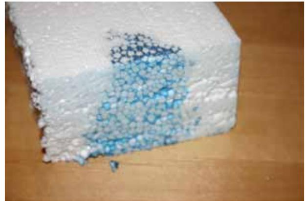
Auf den oberen Bildern kann man sehen, wie Tinte in normales Polystyrol gespritzt, bereits innerhalb weniger Minuten nahezu ungehindert durch eine 10 cm dicke Platte bis zur anderen Seite wandert. Ein Zeichen dafür, dass dieser Dämmstoff viel Wasser aufnehmen und zum Mauerwerk weitertransportieren kann.
